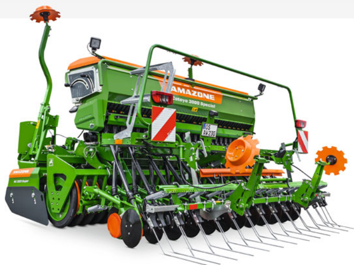
Cataya 3000 Special en largeur de travail 3 m, Mono disque RoTeC-Control, recouvreur FlexiDoigts et trémie de 650 l
